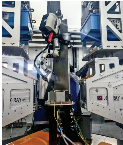
水下焊接原位中子衍射研究装置
